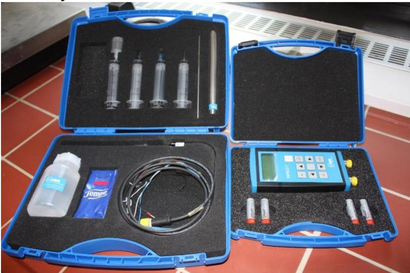
Zur Messung der Bodenwasserspannung bzw. des Matrixpotenzials
