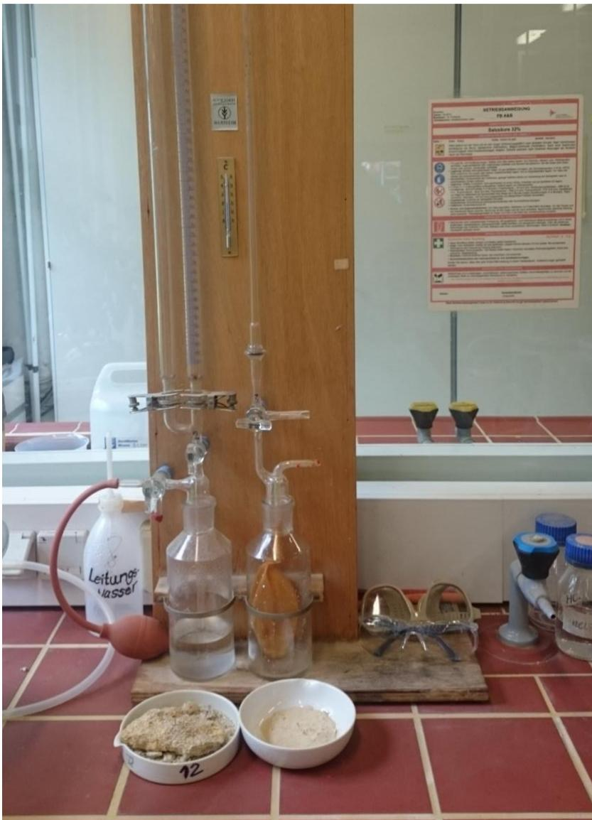
Versuchseinrichtung zur Ermittlung des Kalkgehalts von Böden nach DIN 18129
