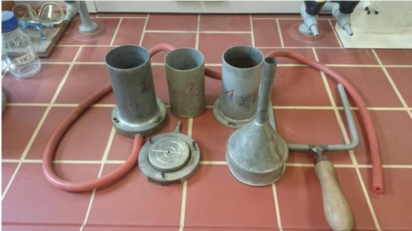
Versuchsequipment zur Bestimmung der lockersten und dichtester Lagerung eines nicht bindigen Bodens nach DIN 18196
