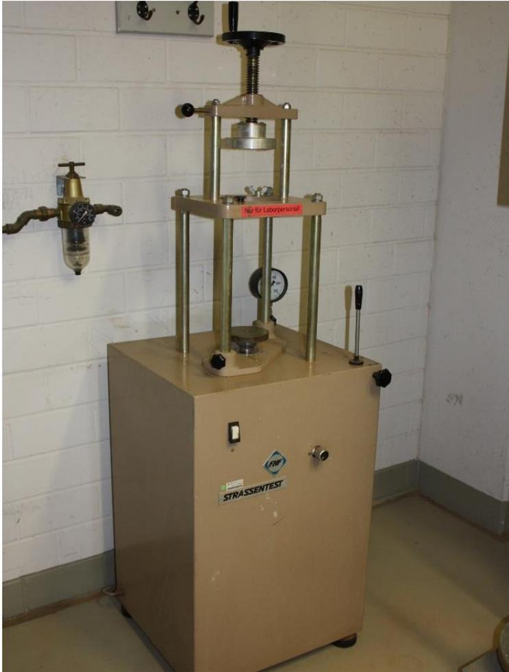
Zum Auspressen von Bodenproben und Asphaltkörpern  $D = 96 \text{ mm}$  und  $D = 150 \text{ mm}$  mit Zusatzeinrichtung für ungestörte Probenentnahme mittels Ausstechen
