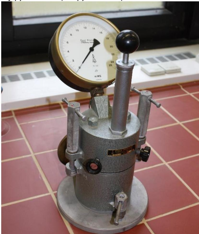
Zur Bestimmung der Korndichte  $\rho_s$  nach DIN EN ISO 17892-3
