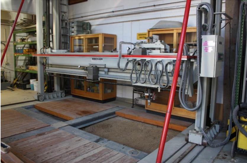
Mit dieser Einrichtung können Zug- und Druckbelastungen (bis zu 160 kN) über moderne Steuerelektronik statisch und zyklisch aufgebracht werden. In unserer bis zu 6 m tiefen Versuchsgrube (4 x 4 m<sup>2</sup>) können auch Modellversuche durchgeführt werden
