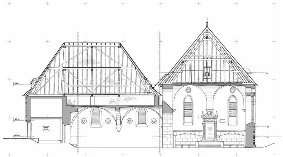
**Gebäudeschnitte in Genauigkeitsstufe III/IV als Ergebnis der tachymetrischen Bauaufnahme der Studierenden.**
