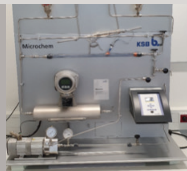
Druckverlustprüfstand mit pulsationsarmer Hochdruckpumpe
